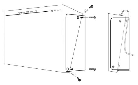
リモコン本体の側面 4 ヵ所のネジ(M3×6)を 取りはずし、ブラケットと本体を 付属品のネジ(M3×8)で固定してください。
