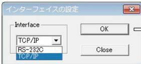
※イーサネット通信の場合でも、各ボードのスレーブアドレスを設定するときおよび本体の IP アドレスを設定するときだけは、RS-232C 通信で設定します。
