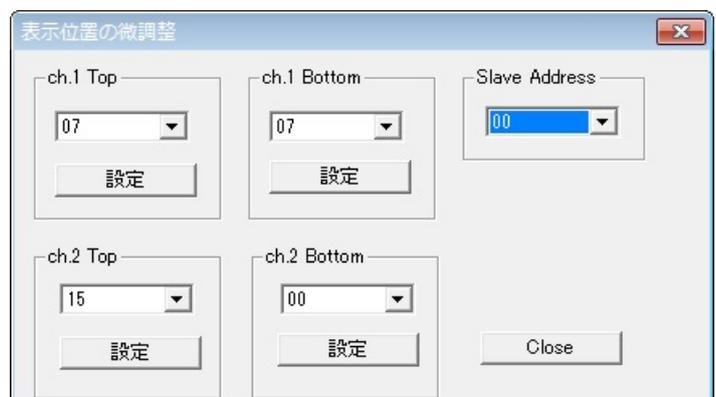
送信する号機を“Slave Address”に設定し、それぞれの“設定”ボタンをクリックすると、ボードに転送・保存されてタイトル位置が調整されます。
