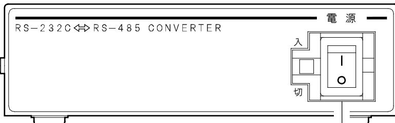
本機の電源を入/切します。通電中は LED(緑)が点灯します。
